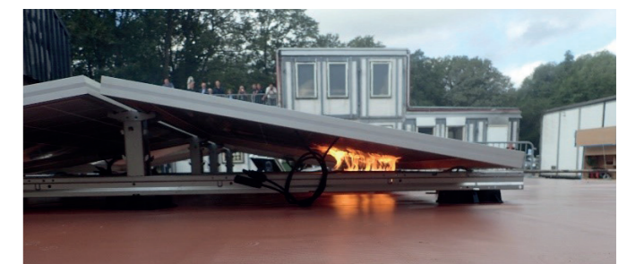
Bild 2 | Versuchsbeginn – Brenner unter den PV-Modulen entzündet
